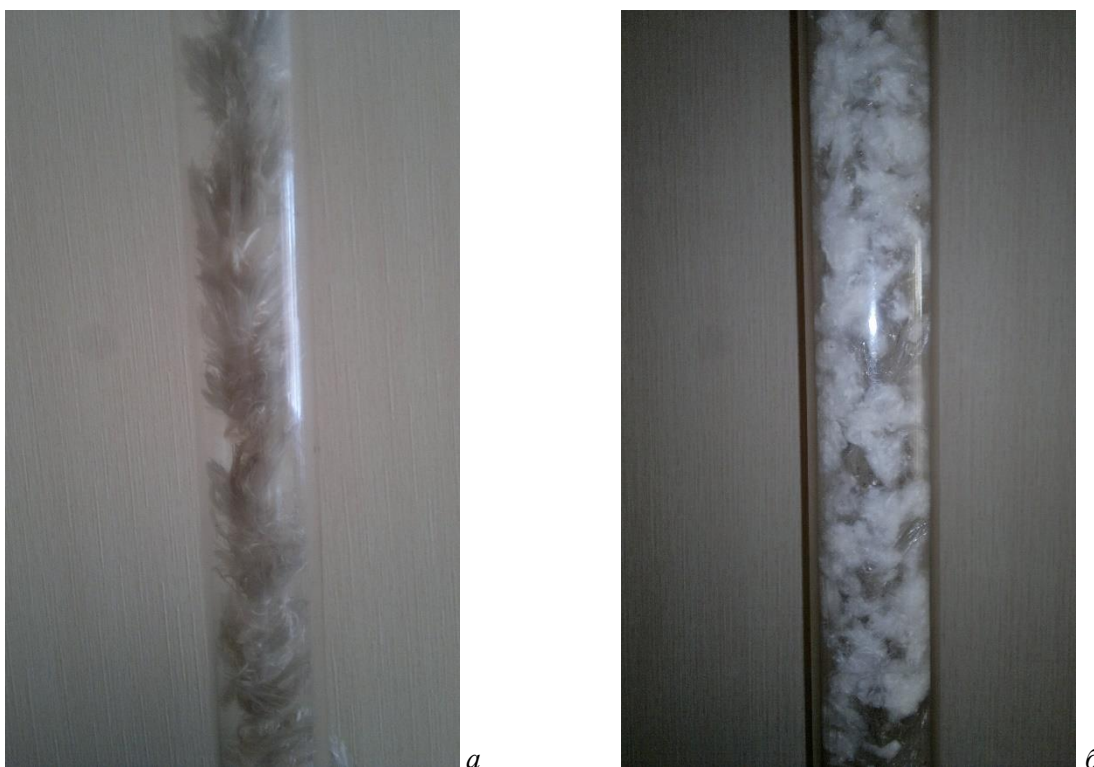
Рис. 2. Модель волокнистої камери утворення пластівців а – напочатку досліду, б – після замулювання осадом.
