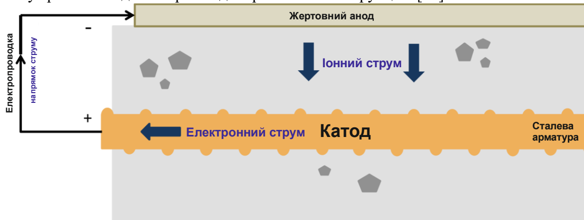
Рис. 5. Схема катодного захисту бетону з «жертвним» анодом [20].
