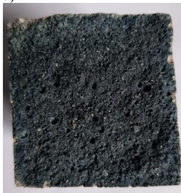
Рис. 4. Фотографії перерізів половинок зразків пластифікованого ШЛЦ бетону на основі метасилікату натрію після розприскування нітрату срібла (а) та ацетату свинцю (б)
