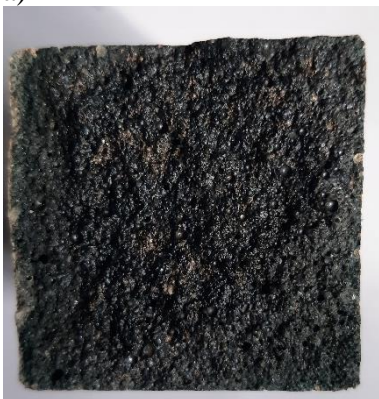
Рис. 4. Фотографії перерізів половинок зразків пластифікованого ШЛЦ бетону на основі метасилікату натрію після розприскування нітрату срібла (а) та ацетату свинцю (б)
