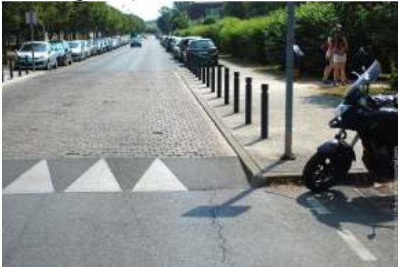
Рис. 3. Способ ограничения скорости автомобильного транспорта перед пешеходным переходом
