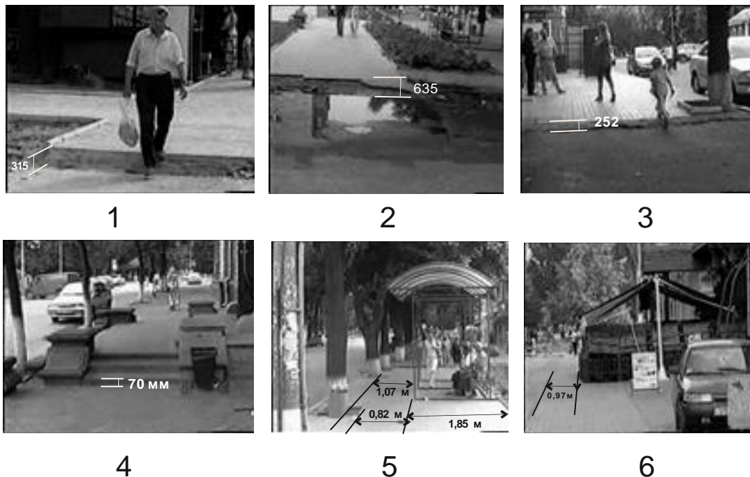
Рис. 1. Порушені ергономічні, композиційні і планувальні вимоги щодо організації пішого руху та торгівлі в просторі вулиць: 1, 2, 3 і 4 – висота сходинки не відповідає ергономічним і санітарно-гігієнічним вимогам; 5 і 6 – звуження проходу спорудами.
