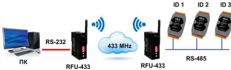
Рис. 6. Застосування радіомодемів RFU-433 для організації взаємодії HOST комп'ютера і вимірювальної частини.
